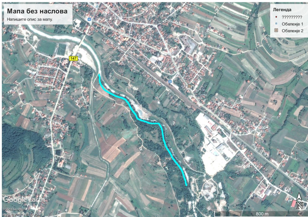
Изградња левообалног насипа од улива Кучајнске реке у дужини од 1.2 km
